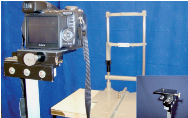
Figura 5 – Lâmpada de fenda adaptada com suporte facial, haste rígida entre paciente e câmera, além do suporte universal com deslizamento horizontal regulável para centralização da imagem em diferentes câmeras fotográficas (Detalhe).
