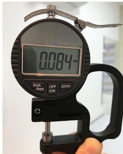
Figura 1. Mensuração da haste capilar com especímetro.
