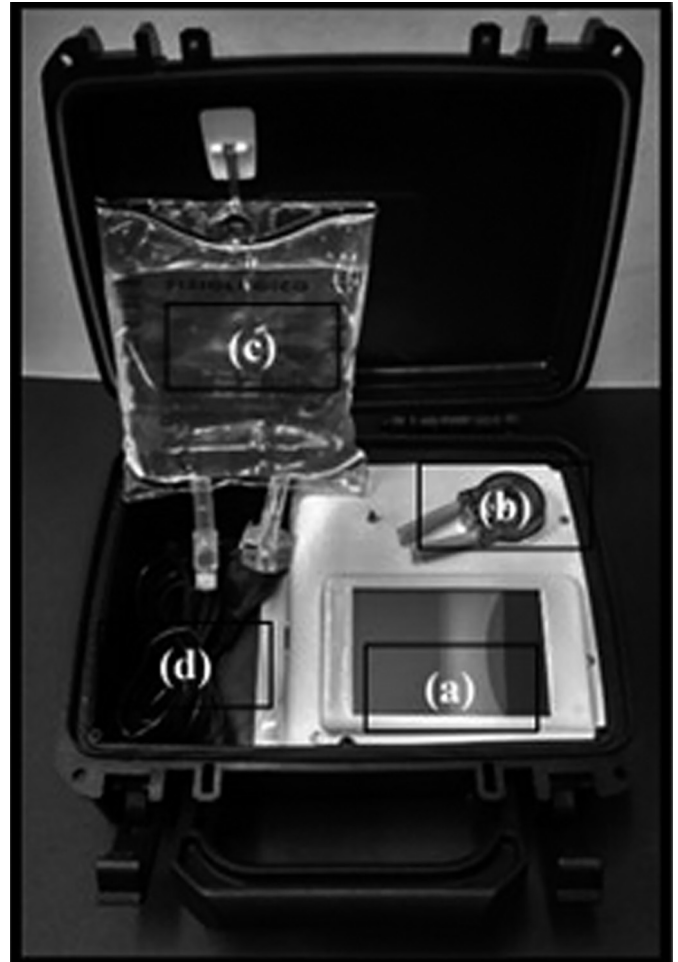
Figura 1. Infusor autônomo: tela (a), bomba (b), solução salina (c) e cabo de eletricidade (d).
