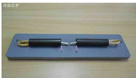
Figura 2 - Simulador montado, com os tendões suínos já posicionados.
