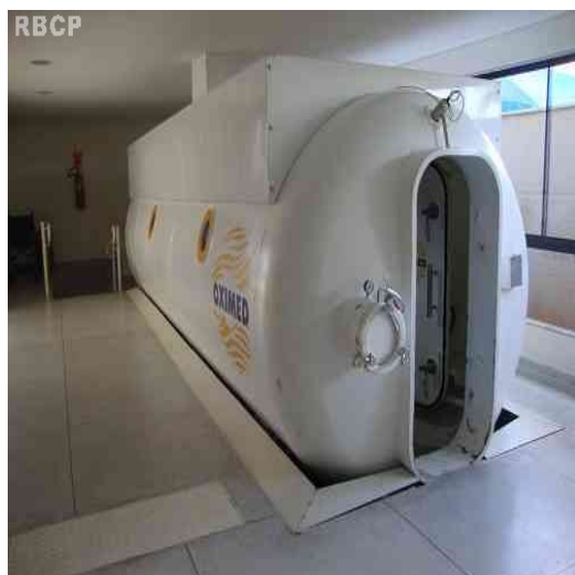
Figura 1 - Câmara hiperbárica permite elevar gradualmente a pressão ambiente e mantê-la sem variações em níveis hiperbáricos pelo período de tempo desejado.
