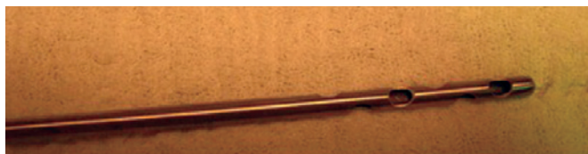
Figura 4 – Cânula de aço, 25 cm x 4 mm.
