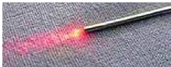
Figura 2 – Fibra óptica exteriorizada e emitindo o laser na extremidade da cânula de 1 mm de diâmetro.
